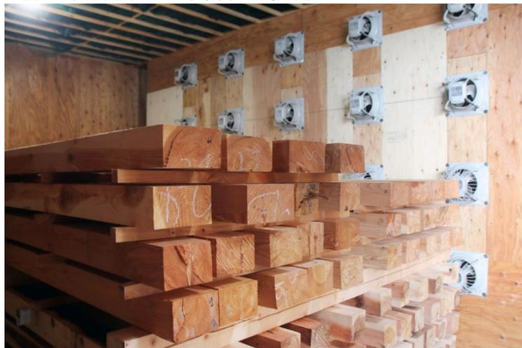
自社開発した廃材・端材を利用する薪ボイラー式乾燥機を活用し、色艶・香りの残る乾燥材を製造
